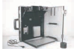
Fotokoffer: transportables Gerät zum Fotografieren z. B. von Schriftstücken, kam vor allem bei geheimen Wohnungsdurchsuchungen zum Einsatz.
