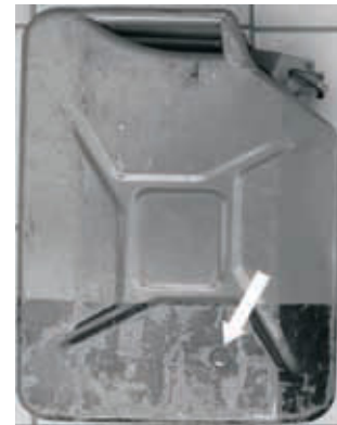
Kanister mit eingebauter Kamera, der Auslöser befindet sich im Griff des Kanisters, der Pfeil zeigt auf die Blendenöffnung
