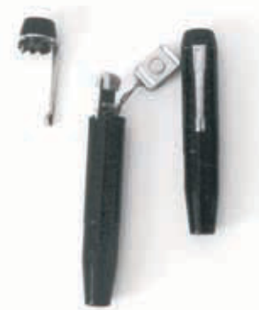
Federhalter mit Wanze: Als Stift in der Brusttasche getragen, konnten so Gespräche aufgenommen werden. Das Aufnahmegerät wurde z. B. in der Hosentasche getragen.
