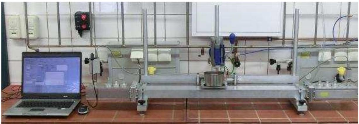
Abb. 67: Aufbau des Messstandes aus Rechner, Resonator und Ofen.
