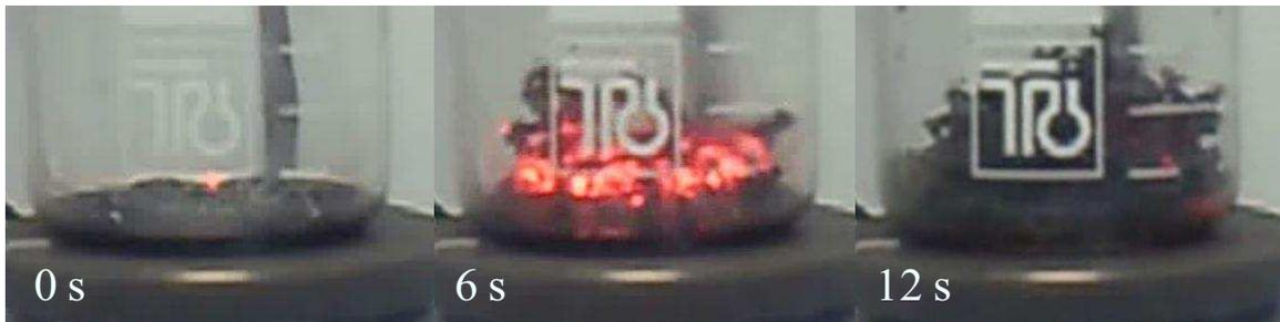
Abb. 21: Verlauf einer Combustion Synthesis CS1 mit Selbstzündung des Gemisches (links), Verlauf unter Glühen (mitte) und Ende der Reaktion (rechts).
