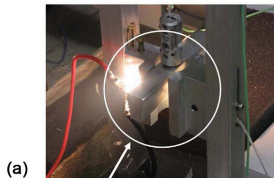
Klemmenführung (Halbschalen) mit integrierter Beleuchtung (links) und Faserzeile (rechts)
