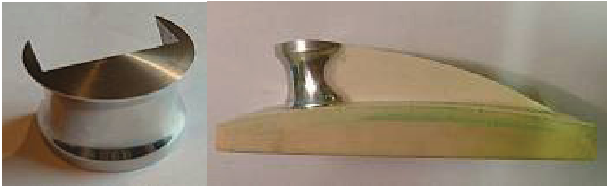
Abbildung 45: Schlagnase mit aus Aluminium hergestelltem Aufsatz zur Gießformherstellung
