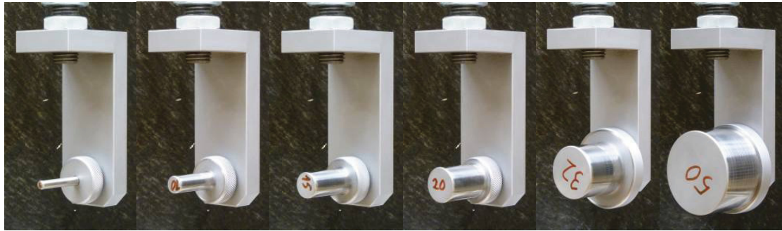
Abbildung 38: Prüfkörper mit unterschiedlichem Durchmesser zur Überprüfung des Fadenschlaufenprüfkonzpts
