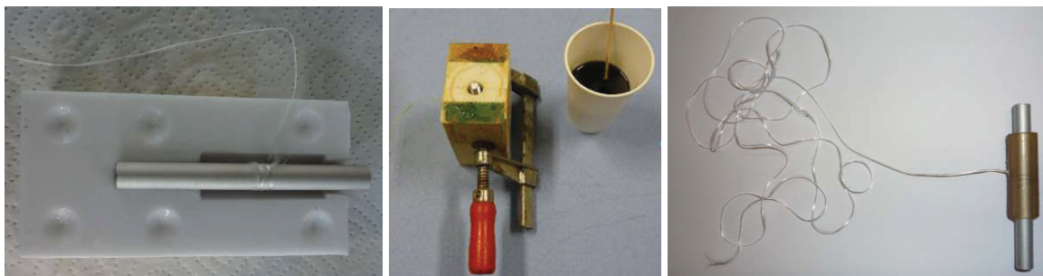
Abbildung 29: Herstellung einer Garnzugprobe mit Garnanker für die Einzelfadenprüfung.
