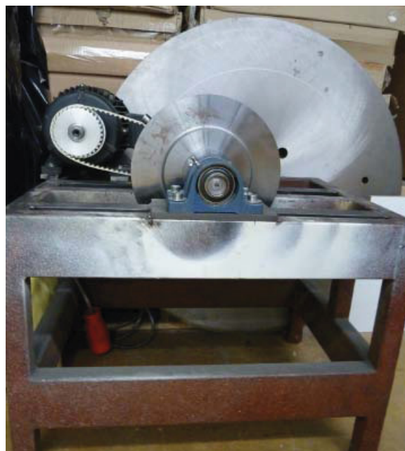
Abbildung 53: Entwicklung eines „kleinen“ Rotationsprüfstands
