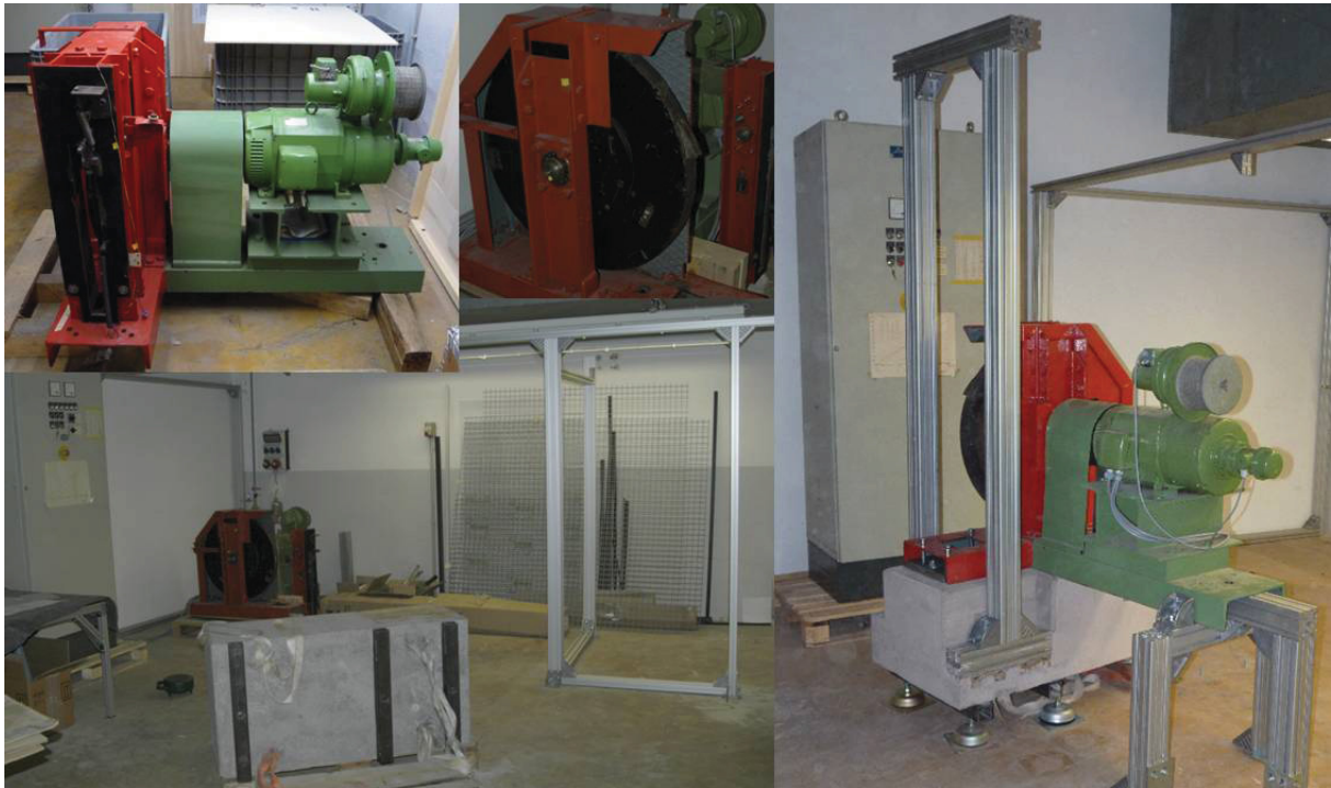
Abbildung 25: Entwicklungsstadien des Rotationszugprüfstands
