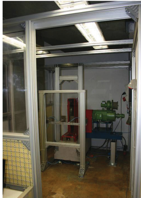
Abbildung 26: Entwicklungsstadien des Rotationszugprüfstands
