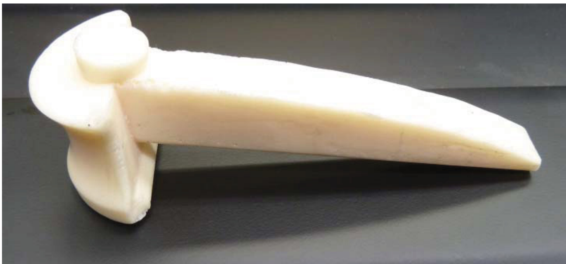
Abbildung 46: Ergebnis des aus PU gegossenen Nasenaufsatzes
