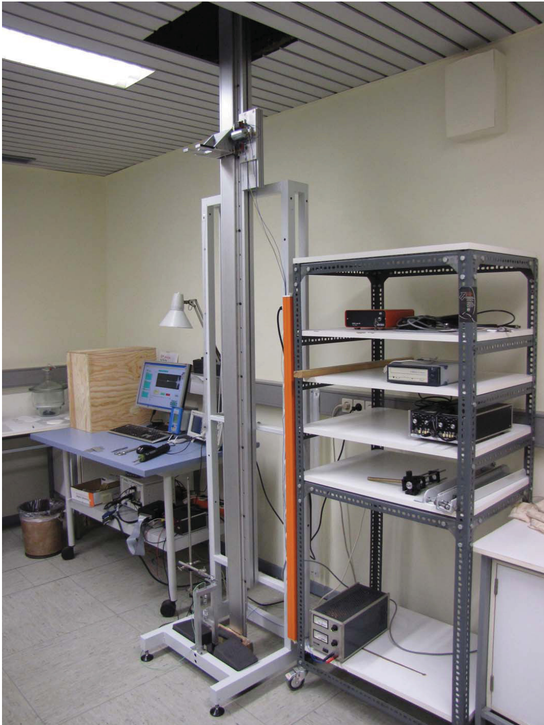
Abbildung 6: Gesamtansicht des Fallgewichtsprüfstands. Der Fallschlitten ist im oberen Bildbereich zu erkennen; er befindet sich - durch die elektromagnetische Auslösevorrichtung fixiert – in seiner Ausgangsposition (Fallhöhe) vor dem Reißversuch. Die eigentliche Garnprüfvorrichtung ist im unteren Bildbereich erkennbar.
