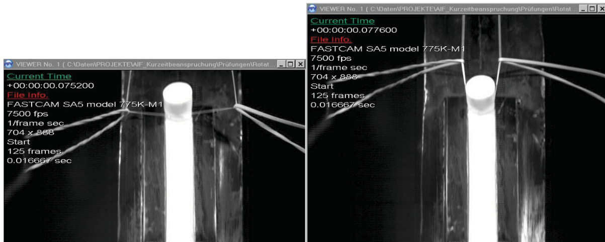
Abbildung 62: Bestimmung des Prüfungsbeginns anhand der High-Speed-Bilder: Links erster geringer Kraftanstieg messbar, rechts Garnabschnitte nahezu gestreckt
