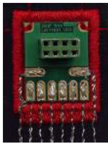
Abb. 5: Detailansicht Kontaktierung mit Kontaktkleber
