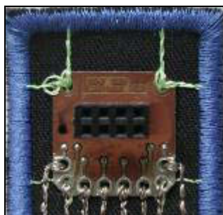
Abb. 3 : Detailansicht Kontaktierung ohne Kontaktkleber
