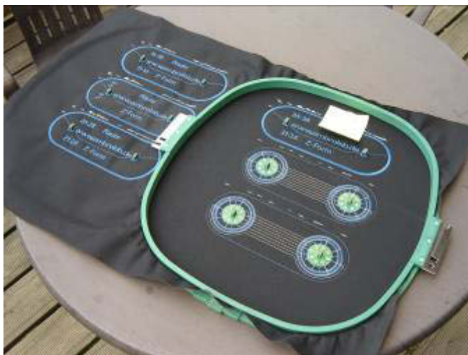
Abb. 64: Versuchsplatinen im Stickrahmen
