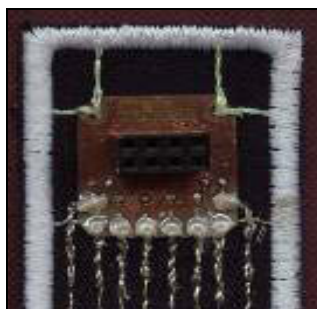
Abb. 2: Detailansicht Kontaktierung mit Kontaktkleber
