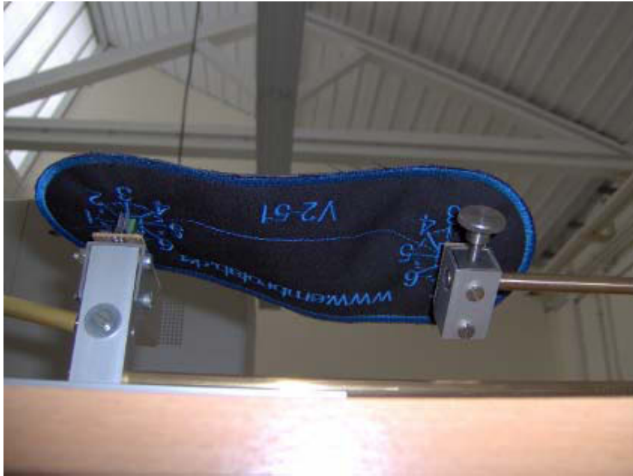
Abb. 70: auf der Testvorrichtung kontaktierte Versuchsprobe
