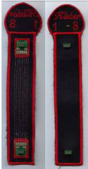
Abb. 4: gestickte Leiterbahnen (davon 1 offen, 3 mit einer Abdeckung versehen, davon 1 (grün) auch von hinten geschlossen)
