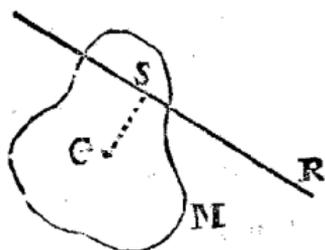
durch die Richtung und den Schwerpunkt geht, den Körper in zwei ähnlichgleiche Theile zerschneidet, so können die Umstände der Bewegung leicht bestimmt werden. Denn erstlich geschieht die Bewegung des Schwerpunktes  $G$  in einer Richtung, die mit  $RS$  parallel ist, und mit einer Geschwindigkeit  $= \frac{R}{M}$ , wenn  $M$  die Masse des Körpers
