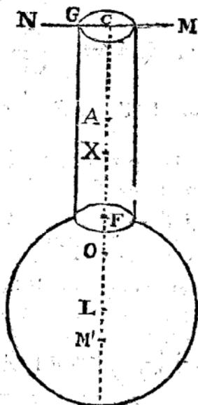
Es sei MN die Ase der Schwingungen, CF = h die Höhe des Zylinders, CG = a der Halbmesser seiner Grundfläche, A sein Schwerpunkt, X sein Schwingepunkt für die Ase MN, L der Mittelpunkt und Schwerpunkt der Kugel, LF = r ihr Halbmesser, M' ihr Schwingepunkt für die Ase MN, O der verlangte Schwingepunkt des ganzen zusammengesetzten Pendels, so ist
