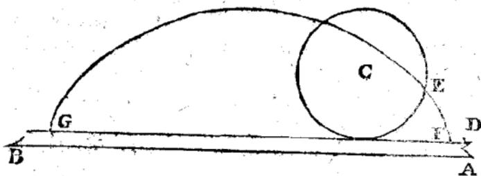
einen kleinen Stift E am Umfange der Rolle, so daß er das Papier berühre. Man stelle die Rolle anfänglich so, daß der Stift E am Lineale in F anliege, und der Faden DF zugleich stramm angezogen sei. Nun schiebe man die Rolle immer weiter nach B hin, so daß sich der Faden allmählig abwickle, und der Stift zuletzt das Lineal wiederum in G berühre, so beschreibet dieser Stift eine Zykloide FEG.
