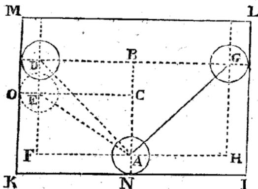
Man bereite einen horizontalen recht ebenen Tisch IKML, in Gestalt eines Rechtecks oder Vierecks, mit einem etwas erhabenen Rande, von harter und unelastischer Materie. Man bereite auch eine Kugel A von der Materie die man probiren will. Man ziehe auf dem Tische gerade Linien mit den Ränden parallel, in der Entfernung des Halbmessers der Kugel. Die eine HF dieser Linien halbire man in A. Man stelle die Kugel irgendwo an dem
