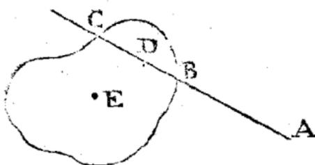
Zum Exempel, wenn man sagt, eine Kraft wirkt auf dem Körper E in der Richtung AC, so kann diese Kraft den Körper, vermöge eines Fadens, von B nach A hinziehen. Sie kann auch, vermöge einer Stange oder steifen Linie AB den Körper E in der Richtung AC stoßen, wenn nur in B ein kleines Fleckchen vorhanden ist, worauf
