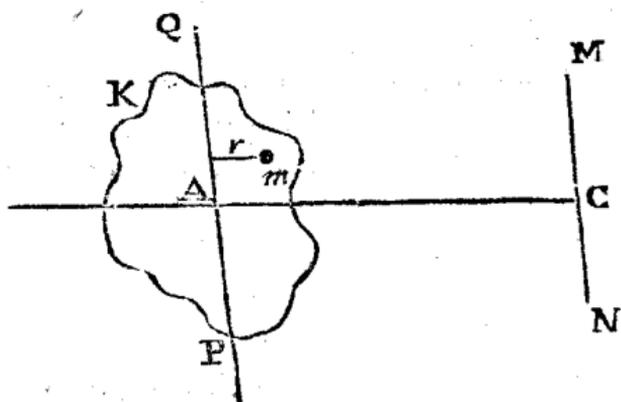
Es sei demnach  $m$  ein beliebiges Theilchen eines Körpers  $K$ , und  $r$  die senkrechte Entfernung des  $m$ , von der Are  $PQ$ , die durch den Schwerpunkt  $A$  geht. Es sei  $MN$  die gegebene Are, mit  $PQ$  parallel, und  $AC$  die Entfernung beider Aren oder die Entfernung des Schwerpunktes von der gegebenen Are, so ist der Exponent der Trägheit in Betreff der Are  $K.AC^2 + \sum mr^2$ .
