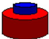
Abb. 4: Aufbau des Prüfkörpers, rot: zylindrischer Grundkörper, blau: Kompositzylinder.
