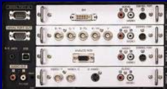
Projektor Anschlußfeld mit wechselbaren Einschüben
