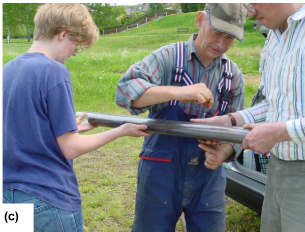
Abb. 3-10 Schritte der inerten Probennahme des Bodentiefeprofils; (a) Bohren, (b) Überführen des Profils per Seilwinde in ein halbiertes aber verschlossenes Plexiglasrohr, (c) Halbieren des Profils, (d) Probenvorbereitung in der Glove-Box (Argon als Schutzgas)
