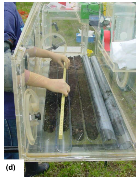
Abb. 3-10 Schritte der inerten Probennahme des Bodentiefeprofils; (a) Bohren, (b) Überführen des Profils per Seilwinde in ein halbiertes aber verschlossenes Plexiglasrohr, (c) Halbieren des Profils, (d) Probenvorbereitung in der Glove-Box (Argon als Schutzgas)
