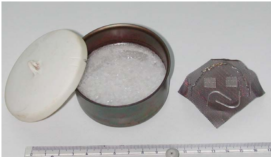
Abbildung 9: Auseinandergestellte Bestandteile des Versuchsaufbaus von links nach rechts: Deckel, Tiegel mit erstarrtem Salz, Gitter mit Proben (die Proben sind mit, im Bild schwer erkennbaren, feinen Platindrähten auf dem Gitter fixiert)
