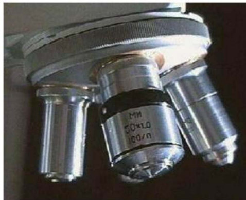
Mikroskop der Baureihe ‚Mikmed‘ und Revolverkopf mit Objektiven zur 10,40,90-fachen Vergrößerung
