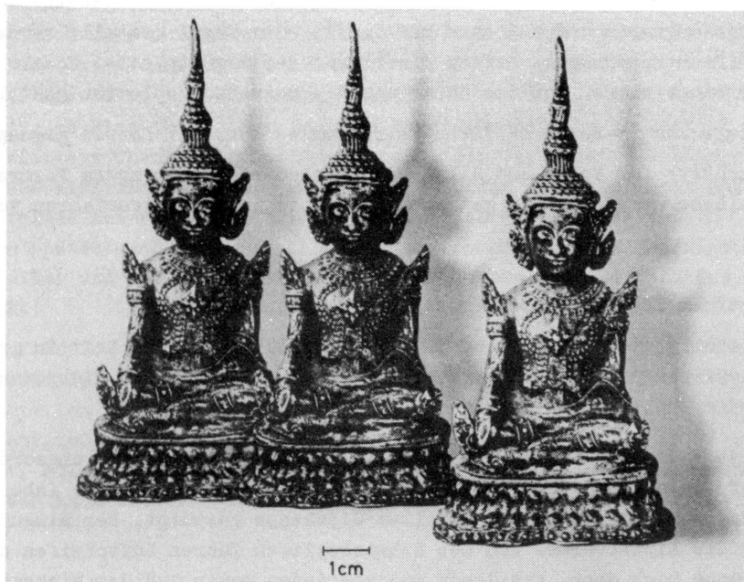
Abb. 59: Metallabgüsse, galvanisiert, aus einer Silicongummiform
