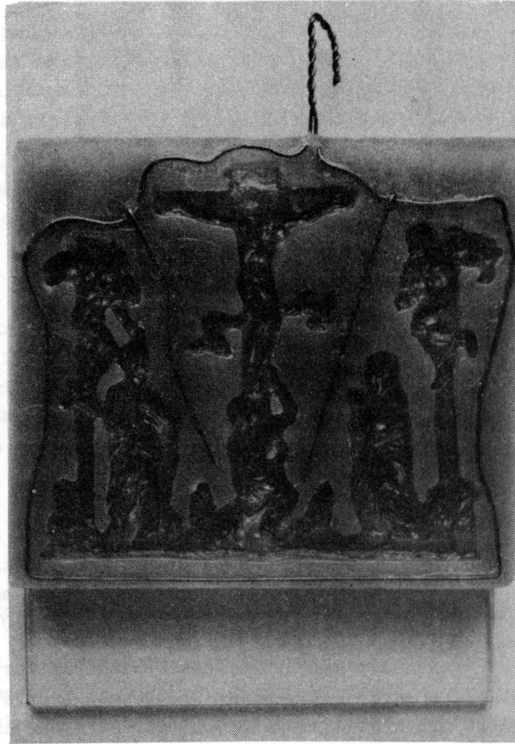
Abb. 91: Wachsform mit eingeschmolzener Zuleitung und Beschwerung
