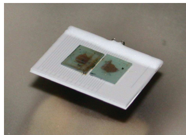
Abb. 22: a) In ECR-Anlage montierter Probentisch mit isolierter Zuleitung. b) Auf Heizelement fixierte SiC-Proben.
