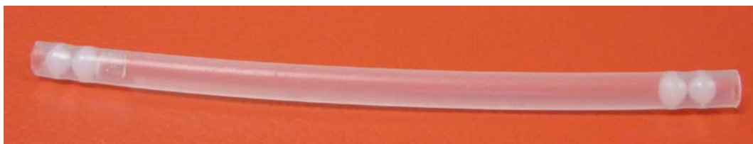
Abbildung 4.4: Permeationsröhrchen mit 60 mm Länge aus Polyethylen (PE).
