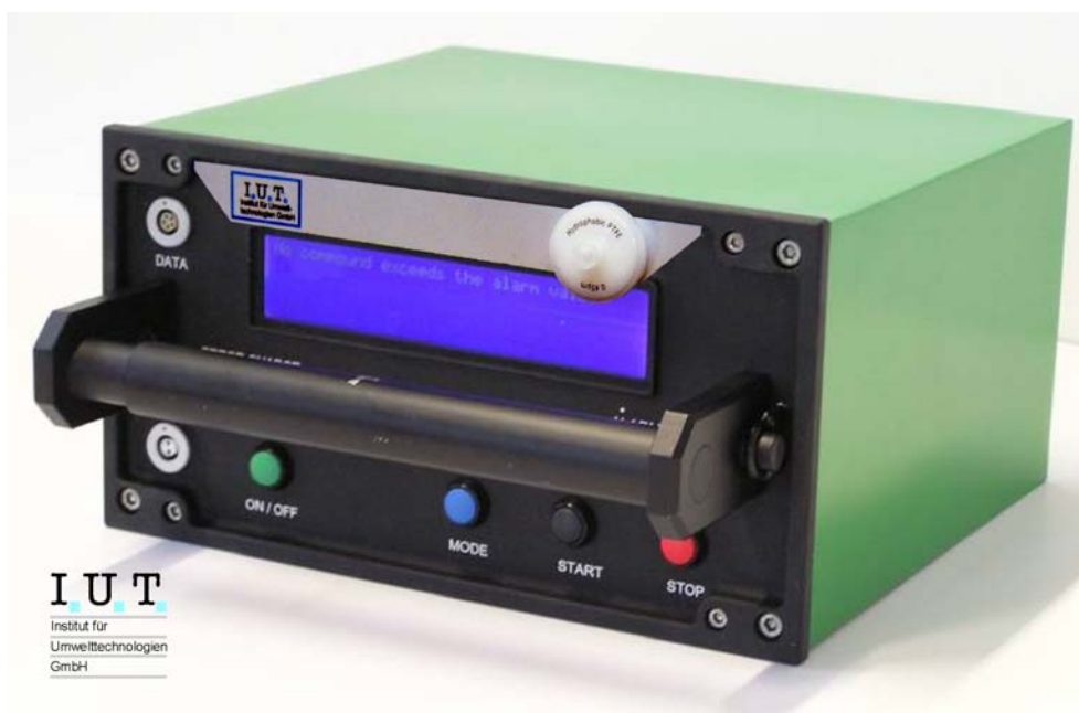
Abbildung 2.2: Verwendetes Ionenmobilitätsspektrometer - IMS-MINI. [67]
