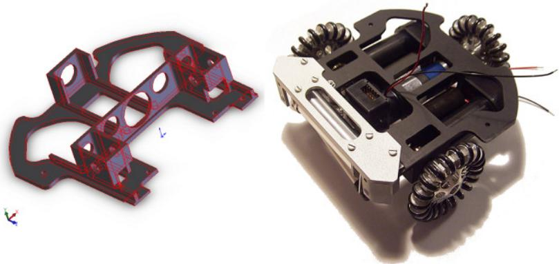
**Abb. 3.4** PA6-Chassis als CAD-Modul und in Bestückung der kompletten Aktorik
