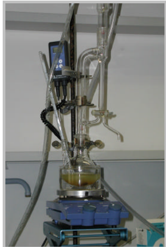
Abb. 7: Aufbau Apparatur - Ölbad
